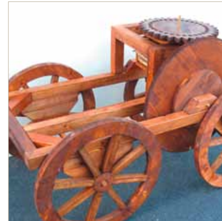
Nachbau eines römischen Messwagens (Hodometer)
